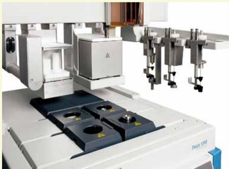
TriPlus RSH自动采样系统安装到TRACE 1310气相色谱仪包括自动工具转换平台。
